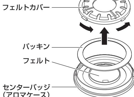
フェルトはセンターバッジ（アロマケース）のフェルト収納部から浮き・はみだしがないようにツメの下になるようにセットしてください。 フェルト
