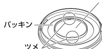
フェルト交換時もフェルトをツメの下になるようにセットしてください。
